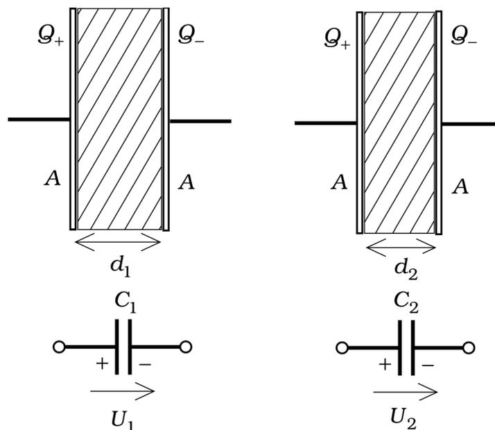
und anschließend miteinander verbunden, dann werden die beiden inneren Kondensatorplatten wegen der entgegengesetzt gleichen Ladungen ladungsfrei und es bleiben die beiden äußeren Platten mit dem Ladungspaar  $(Q_+, Q_-)$  übrig, aber der Abstand dieser Platten hat sich auf
