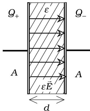
Zwei Metallplatten der Fläche  $A$ , die durch ein isolierendes Material im Abstand  $d$  voneinander getrennt gehalten werden, bilden einen **Kondensator**. Wird die eine Platte mit der positiven Ladung  $Q_+$  und die andere mit der gleich großen aber negativen Ladung  $Q_-$  aufgeladen, so entsteht zwischen den beiden Platten ein elektrisches Feld  $\vec{E}$  und die Spannung
