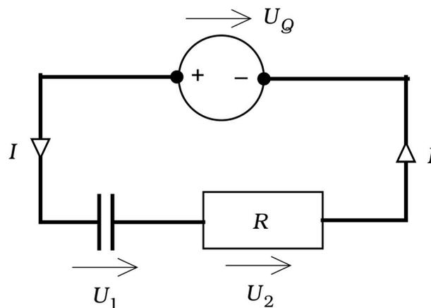
Verbindet man einen zunächst ungeladenen Kondensator über einen Widerstand mit einer Spannungsquelle konstanter Quellenspannung  $U_Q = U_0$ , so entsteht ein Ladestrom  $I(t)$  und es gilt
