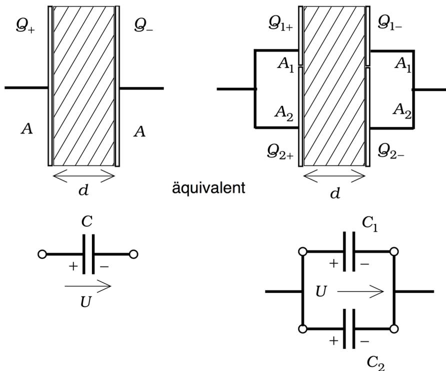
entstehen zwei parallel geschaltete Kondensatoren mit anderer Kapazität und wenn beide Teilplatten mit den Ladungen  $(Q_{1+}, Q_{1-})$  und  $(Q_{2+}, Q_{2-})$  aufgeladen werden, wobei
