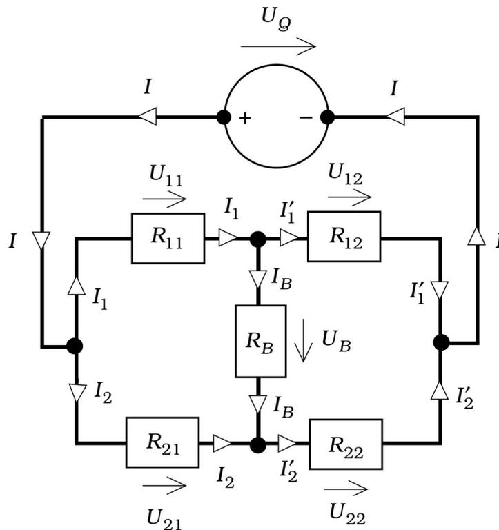
Insgesamt sind bei gegebener Quellenspannung sechs Stromstärken unbekannt. Zur Verfügung stehen die Gleichungen
