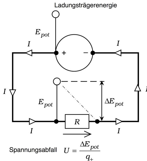
so beruht die Abnahme der potentiellen Energie auf der Umwandlung elektrischer Energie in eine andere Energie (z.B. Wärme in einem OHMSchen Widerstand).
