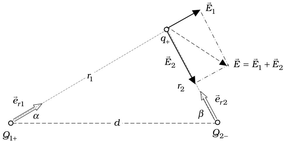
Der Feldvektor  $\vec{E}$  ist jeweils Tangentenvektor an die Feldlinie am Ort der Probeladung  $q_+$ .
